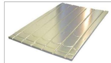
**Piastra base preformata ad U** per il facile ancoraggio del tubo in polietilene diam 12x2 mm, realizzata in polistirolo espanso conforme alle normative EN 13163, DIN 4108-10.
